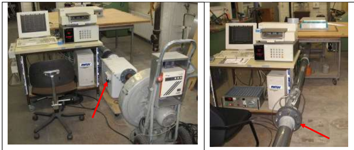
Abbildung 3: Prüfaufbau für die Messung der Leckage links: Gasuhr (exempl. G40) für kleinere Leckvolumenströme . rechts: Messblende für Leckvolumenströme > 65 m 3 /h.
