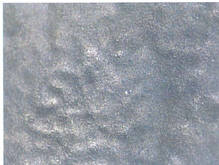
Foto 2: Untersuchungsmaterial EVS-80 E Se (beschichtetes Gewebematerial) , Farbe schwarz nach einer Inkubationszeit von 28 Tagen ohne Pilzwachstum (50fach vergrößert)
