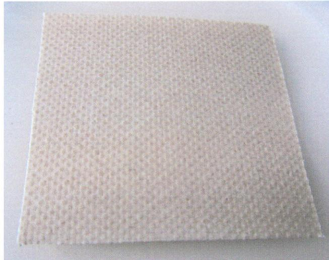
Foto 1: Untersuchungsmaterial **EVS-300 VD Se (beschichtetes Gewebematerial)**, **Farbe beige** nach einer Inkubationszeit von 28 Tagen ohne sichtbaren Pilzwuchs
