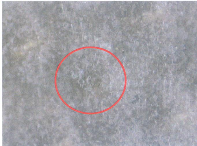
Foto 2: Untersuchungsmaterial **EVS-300 VD Se (beschichtetes Gewebematerial)**, **Farbe beige** nach einer Inkubationszeit von 28 Tagen mit leichtem Pilzwachstum (50fach vergrößert)
